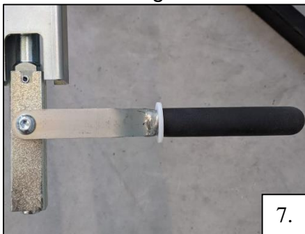
7 Nutzen Sie zum Befestigen Ihr Körpergewicht, in dem Sie die Handgabel seitlich anwinkeln und herunterdrücken. Anschließend wieder neu ansetzen.
