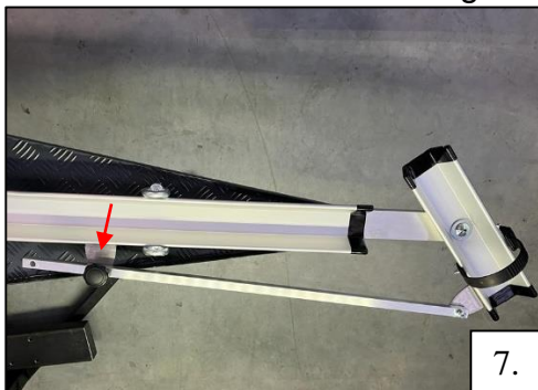
7 Mittels der Sterngriffschraube kann die Standschiene quer gestellt werden. Dies ist abhängig von den Maßen des Dreirades.
